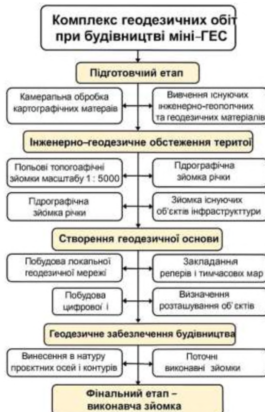
Рисунок 1. Блок-схема комплексу геодезичних робіт при будівництві
