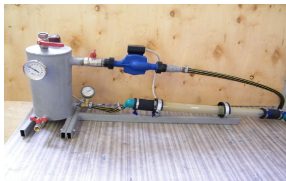
Рис. 1. Схема (а) і загальний вигляд (б) кавітаційного реактора: 1 – місткість з нагрівачем, 2 – кран, 3 – насос, 4 – кран, 5 – корпус (прозорий), 6 – діафрагма, 7 – кран.
