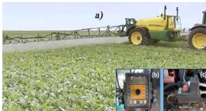
Рис. 1. Штанговий обприскувач M700, використаний для тестування продуктивності розпилення(а); Регулятор норми внесення Micro-Trak MT-2405F II, встановлений у 2024 році (b); Регулюючий клапан TeeJet® 346BPR-2F-03, використаний у 2024 році(с).
