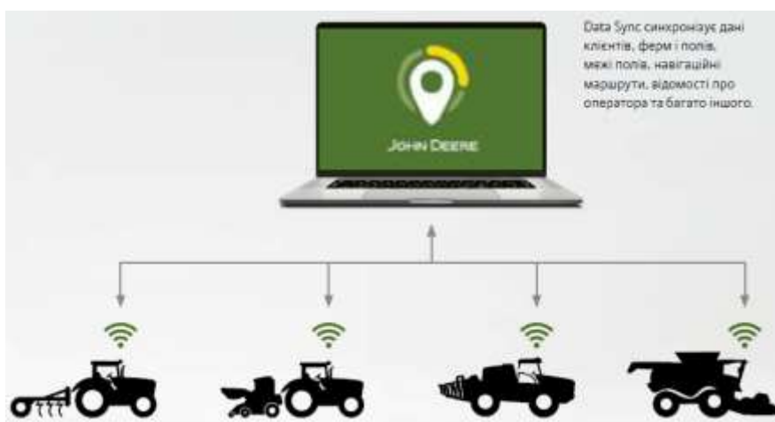
Рис. 3. Синхронізація та передача даних між агрегатами.
