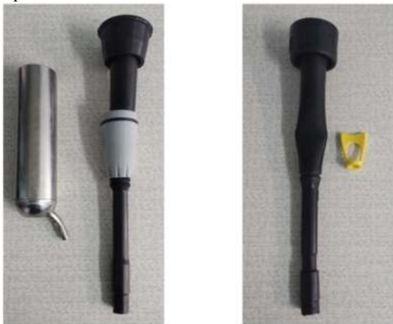
Рис. 1. Загальний вигляд формувальних вставок: а - для міжстінного простору доїльного стакану; б - для піддійкового простору доїльного стакану.
