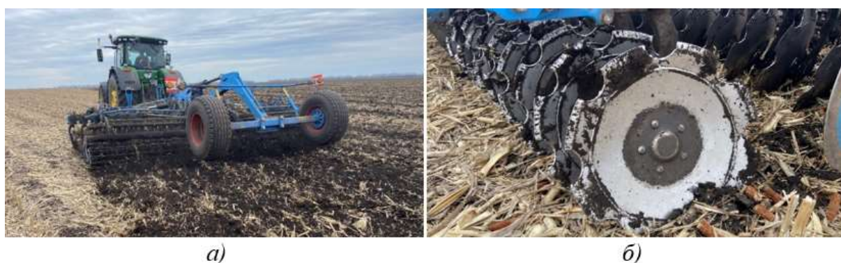
Рис. 2. Загальний вигляд дисків важких борін Lemken Rubin в процесі дослідно-виробничих випробувань: а) дискова борона Lemken Rubin 10; б) відновлені диски
