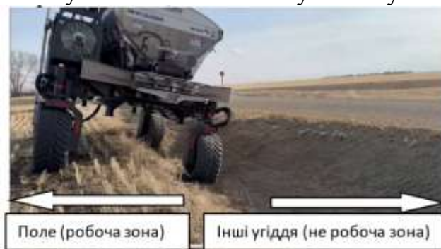
Рис. 2 Виїзд агрегату за межі виробничої зони поля при зникненні сигналу GPS.
