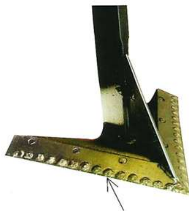
Рис. 5. ніж плоскоріза (лапа культиватора) - наробіток 350-600 га, твердість крапки зміцнення HRC 60 65.
