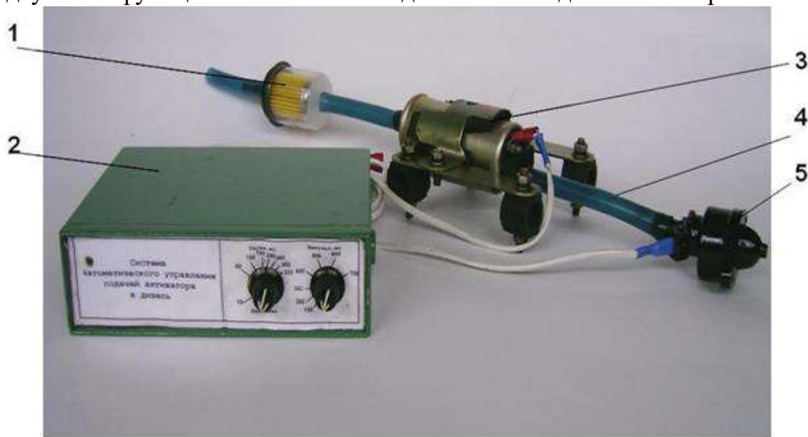
Рис. 5. Загальний вигляд системи одноточкового впорскування паливного активатора (найменування позицій у тексті).
