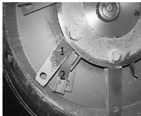
Рис. 3. Ротор з молотками дробарки БМК-1: 1 - серійні, 2 – експериментальні зі вставками з X13M2 - Cr_3C_2 - V_4C
