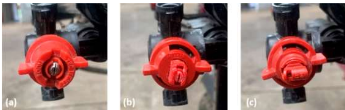
Рис. 2. Три різні типи форсунок TeeJet®(а): XRC 11004 – створює середні краплі, AIXR 11004 – створює дуже великі краплі (b), TTI 11004 – створює надвеликі краплі (с).
