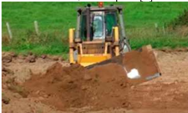
Рис. 2. Робота бульдозерного агрегату з перекосом відвала.
