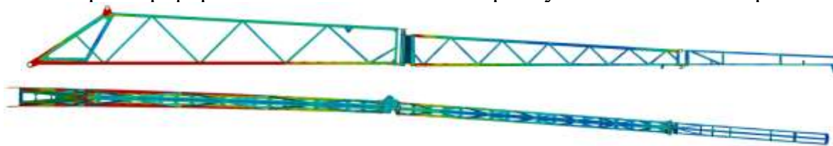
Рис. 4 Форма коливань штанги польового обприскувача (мода 1)
