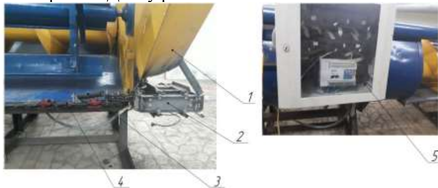
Рис. 2. Лабораторний експериментальний зразок електропривода ДРА жатки з фронтальним розташуванням ДПЛАД: 1 – корпус жатки; 2 – ДПЛАД; 3 – пружний накопичувач механічної енергії; 4 – верхня ножева смуга ДРА; 5 – система керування роботою ДПЛАД у приводі ДРА жатки
