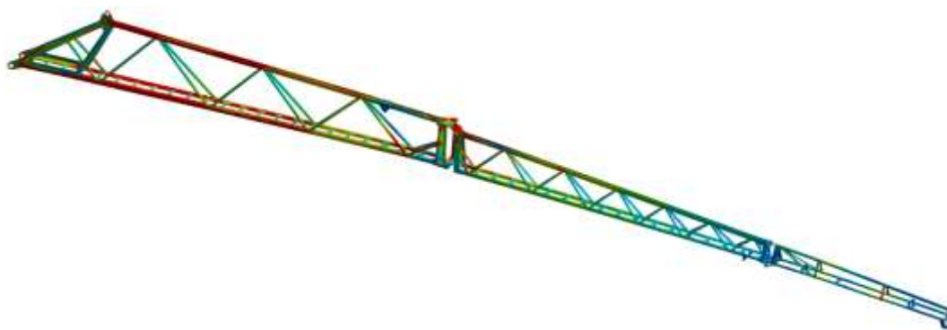
Рис. 2 Ізограма статичних напружень штанги польового обприскувача
