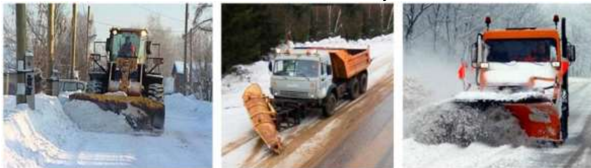
Рис. 3. Робота снігоочисного трактора з поворотним відвалом.
