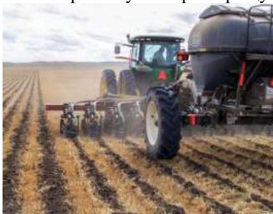
Рис. 2. Застосування технології Strip-till.
