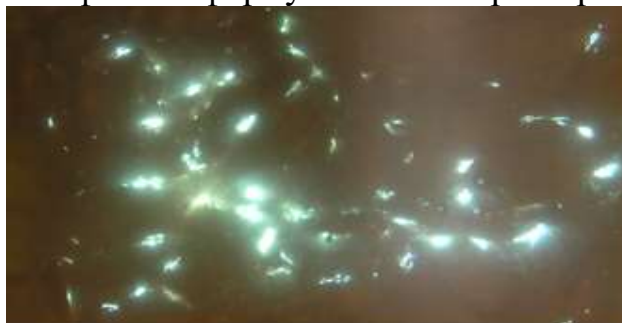
Рис. 1. Утворення плазмових каналів між гранулами заліза.
