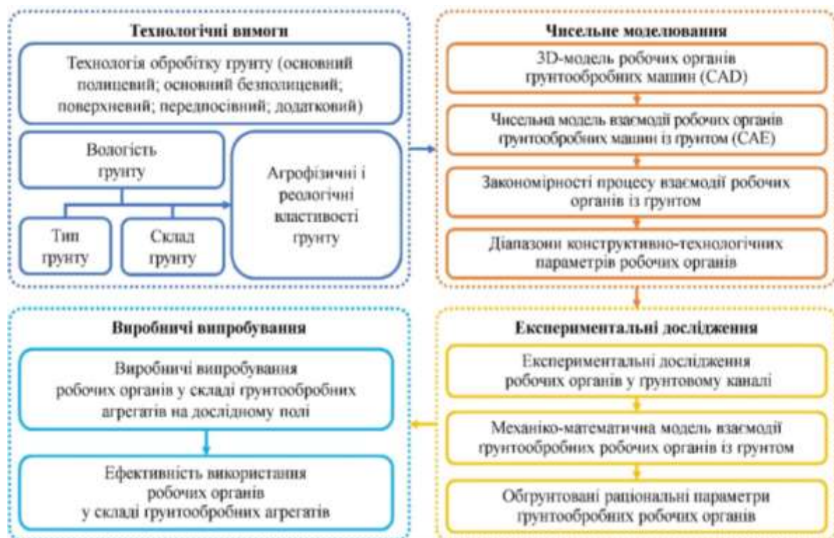
Рис. 1 Методика проектування ґрунтообробних знарядь
