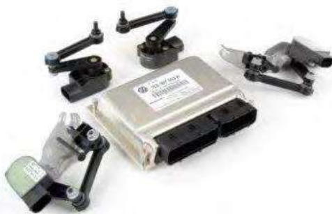
Рис. 3. Електронний блок керування з датчиками.
