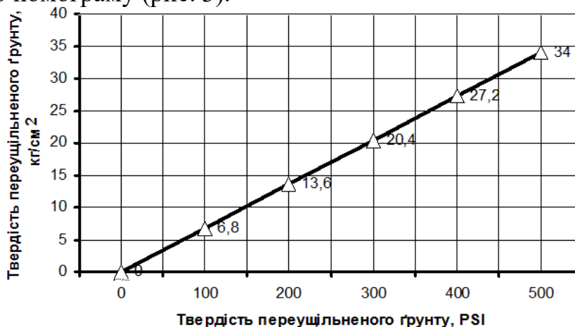
Рис. 3. Номограма переведення показів манометра пенетрометра з одиниць PSI (фунт на квадратний дюйм) в одиниці метричної міри
