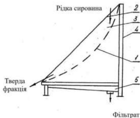
Рис. 2. Технологічна схема «дугового» сита
