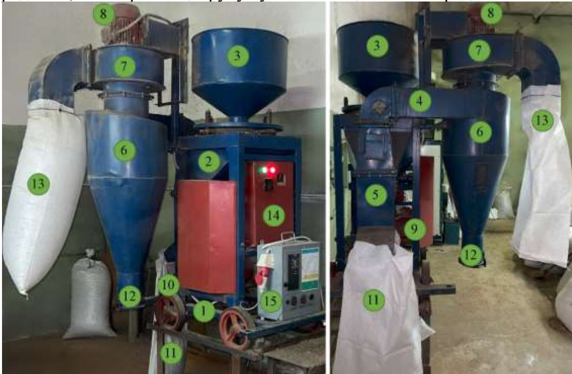
Рис. 1 Стенд для дослідження машини для очищення насіння рицини: 1 – станина; 2 – система відокремлення насінин рицини від плодів; 3 – завантажувальний бункер; 4 – система аеродинамічного очищення; 5 – пневмосепаруючий канал; 6 – циклон; 7 – відцентровий вентилятор; 8 – електродвигун вентилятора; 9 – основний електродвигун; 10 – забірник насіння; 11 – забірник нерозлучених плодів; 12 – забірник частинок коробочок; 13 – забірник дрібних частинок і пилу; 14 – блок керування; 15 – частотний перетворювач Danfoss Micro Drive
