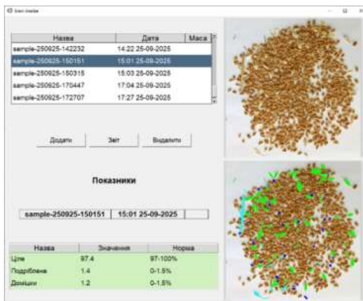
Рис. 1. Інтерфейс програмного забезпечення для аналізу та розпізнавання зернових матеріалів з використанням машинного зору.
