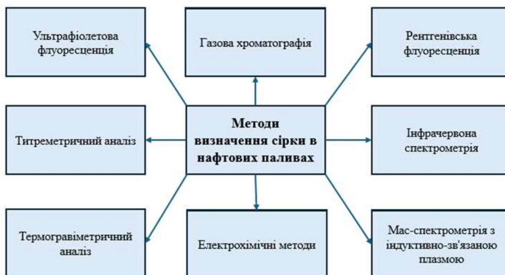
Рис. 1. Методи визначення сірки в нафтових паливах
