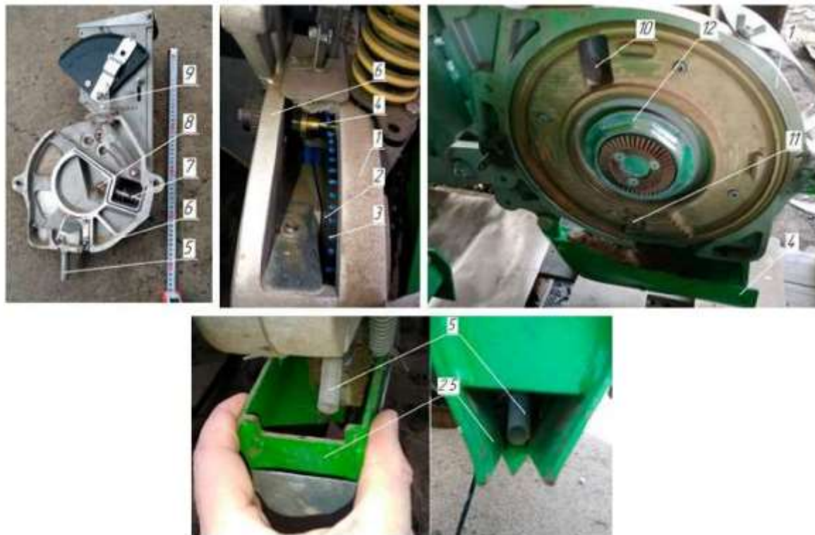
Рис. 5. Пневматичний висівний апарат сівалки точного висіву SFOGGIA Calibra (Італія): 1 – корпус висівного апарату; 2 – висівний диск; 3 – отвір висівного диска; 4 – ексцентрик; 5 – насіннепровід; 6 – кришка висівного апарату; 7 – забірна камера; 8 – привід ворошилки насіння; 9 – відсікач двійників; 10 – зона розрідження; 11 – зона надлишкового тиску; 12 – посадкове місце висівного диска
