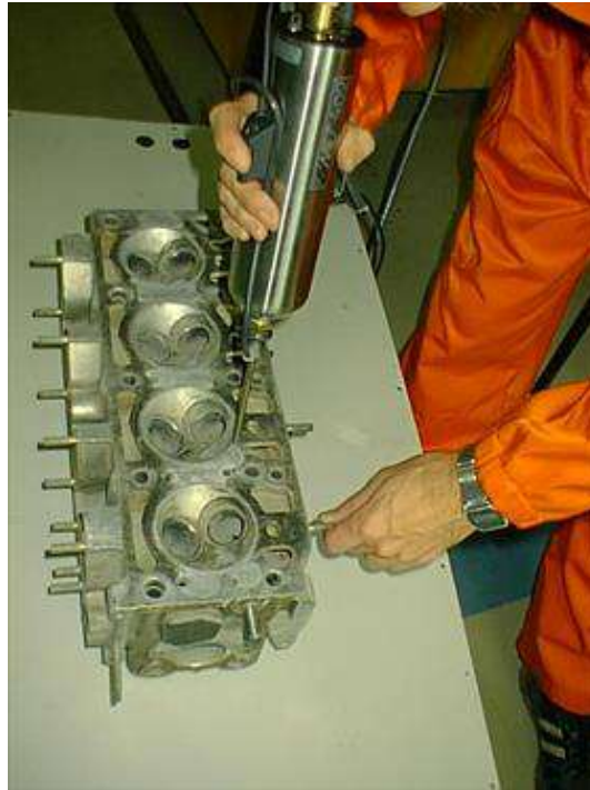
Рис. 4. Спосіб газодинамічного формування металевих покриттів обладнання ДІМЕТ®.
