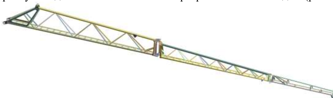
Рис. 1 CAD-модель штанги широкозахватного польового обприскувача
