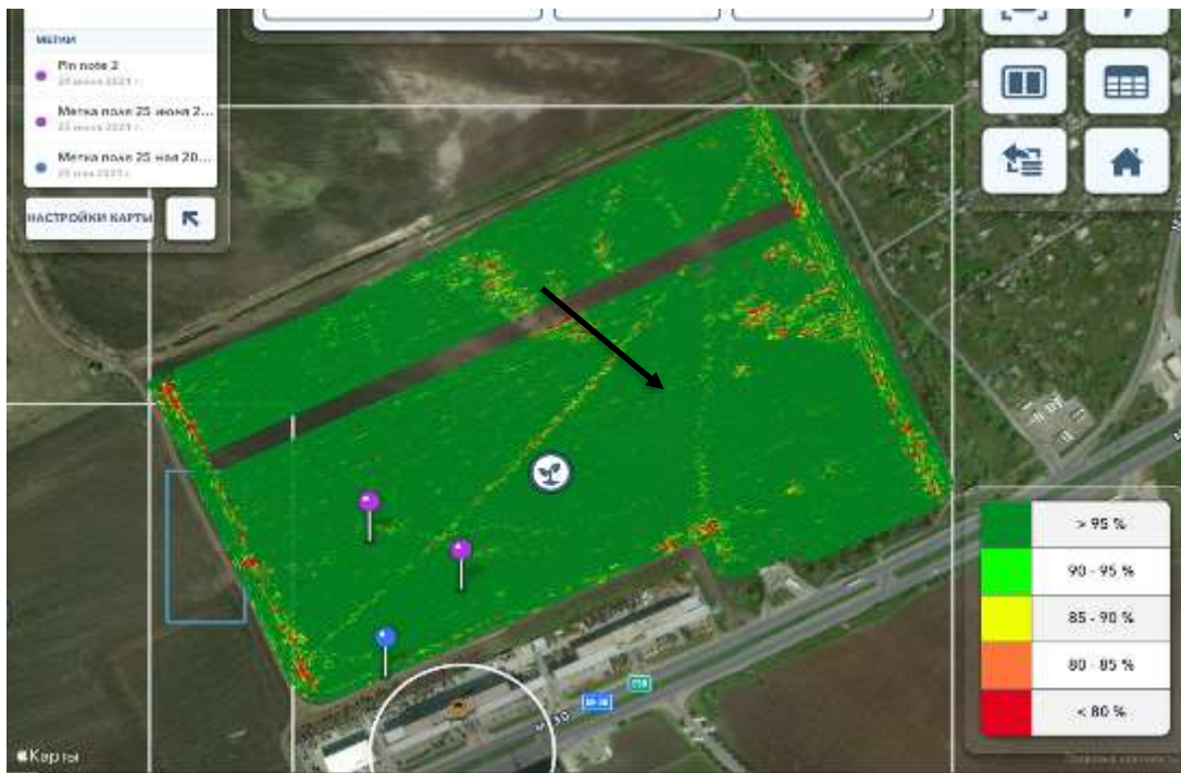
Рис. 1. Характеристика зміни величини вібрацій від місця розташування посівного МТА на полі
