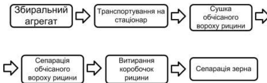
Рис.1. Структурна схема технологічного процесу очісування рицини.
