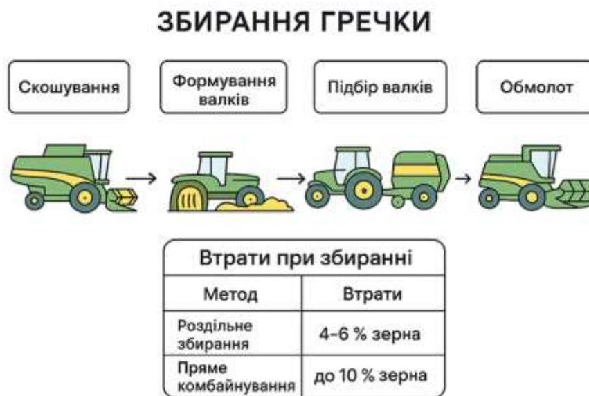
Рис. 1. Технологічні операції збирання гречки та втрати врожаю
