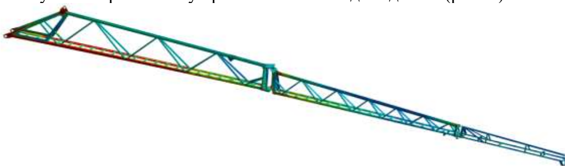
Рис. 3 Ізограма напружень за результатами модального аналізу (мода 1)
