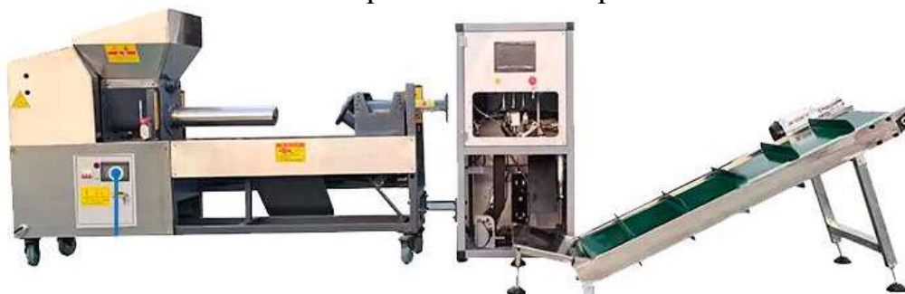
Рис. 2. Схема існуючої технології створення субстратного блоку за допомогою гвинтового (шнекового) формувача блоків.
