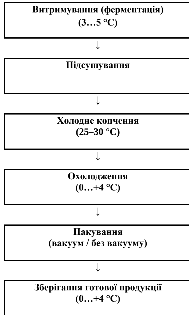
Рисунок 4.25. Технологічна схема виробництва риби холодного копчення типу «Кіперс»
