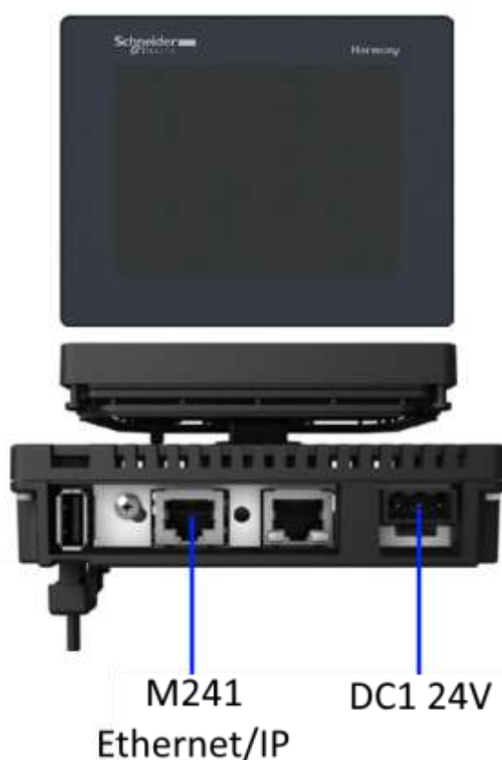
Рисунок 4.5 – Сенсорна панель Magelis HMISTU855
