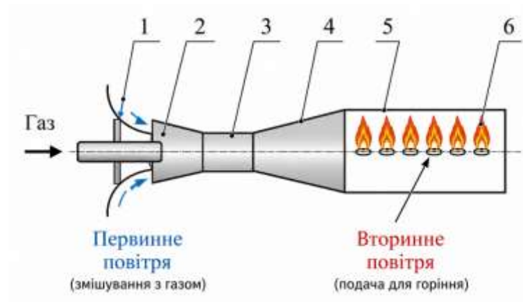
Рисунок 1.7 – Принципова схема інжекційного газового пальника: 1 – сопло; 2 – регулятор первинного повітря; 3 – конфузур; 4 – горловина; 5 – дифузур; 6 – насадка змішувача-інжектора
