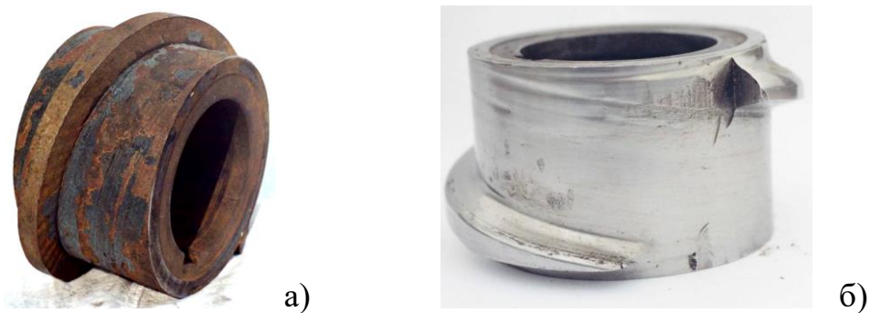
Рис. 1. Виток шнека: а – новий; б - після 2-ох місяців експлуатації.
