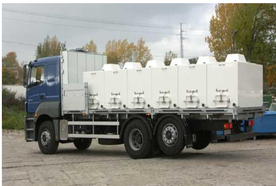
Рис. 1. Автомобіль, обладнаний для транспортування живої риби (молоді і плідників) та його обладнання
