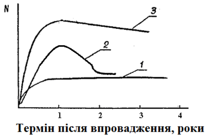
Рис. 1. Залежність відмов від рівня керування якістю: N – число відмов у рік; 1 – крива відмов в умовах керування якістю; 2 – крива відмов в умовах системи контролю якості; 3 – крива відмов в умовах відсутності системи керування якістю.
