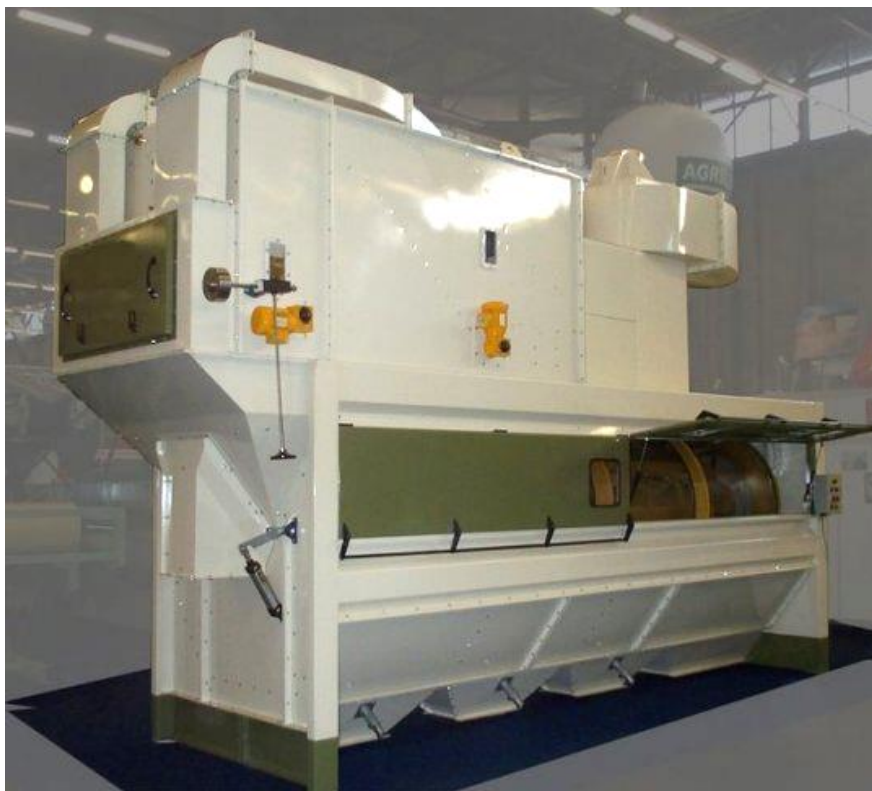
Рис. 2. Зерноочисна машина барабанного типу
