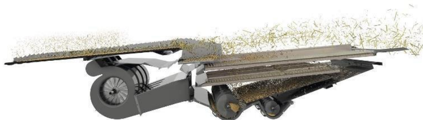
Рис. 1. Система очищення JetStream комбайнів Claas Lexion 750/760/770.
