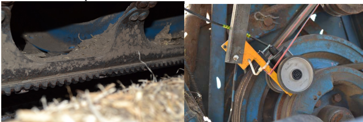
Рис. 1.: а) розміщення неврівноваженої маси на підбичниках молотильного барабана; б) встановлення лінійного енкодера
