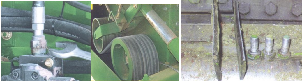
Рис. 3. Ніж, накладки і кріпильні болти, пошкоджені в результаті контакту з камінням.
