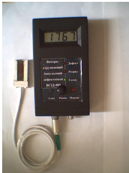
Рис. 1. Зовнішній вигляд вихорострумowego імпульсного дефектоскопа для виявлення малих експлуатаційних тріщин.
