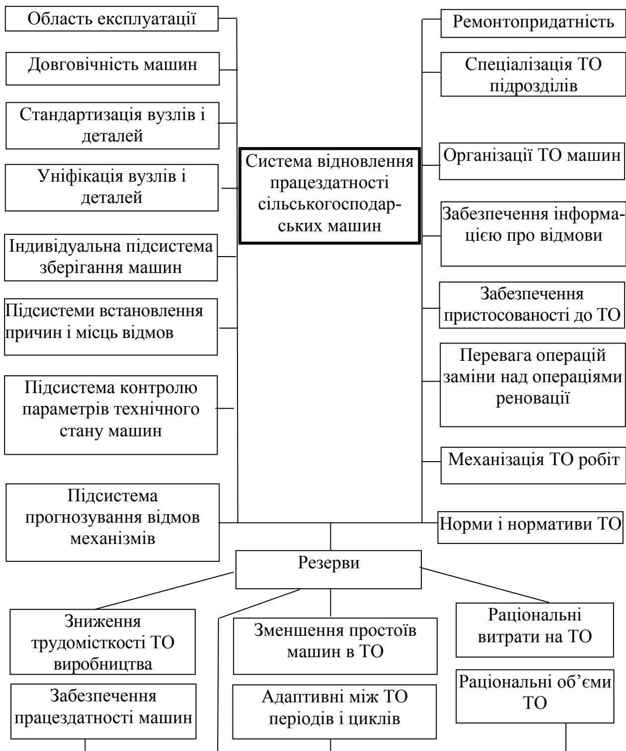
Рис. 1. Чинники дії на забезпечення відновлення працездатності систему технічного обслуговування і ремонту обладнання.
