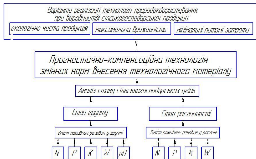
Рис. 3. Реалізація прогностично-компенсаційної технології змінних норм внесення технологічного матеріалу.
