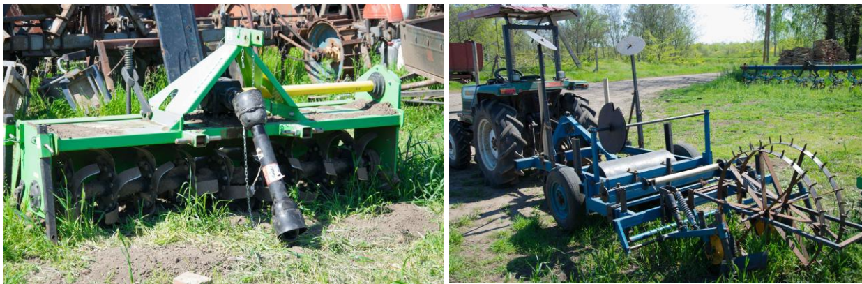
Рис. 2. Загальний вигляд машин для утворення гряд у ТОВ «Агро-Фенікс» Мелітопольського району Запорізької області: а) фреза ґрунтообробна; б) комбінований грядоутворювач пасивний.
