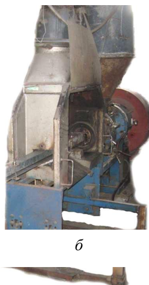
Рис. Гвинтовий прес для брикетування ВВ: а – конструкційна схема преса; б – загальний вигляд преса.
