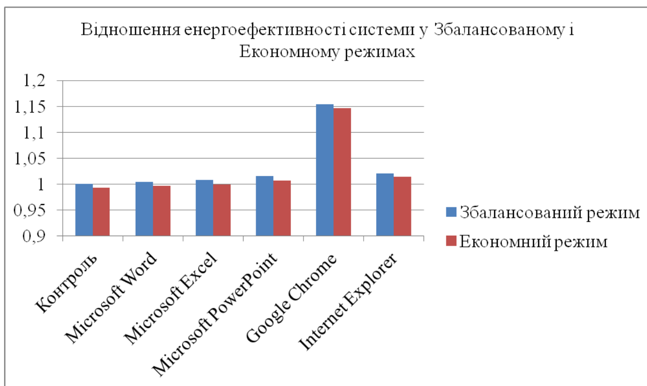
Рис. 1. Відношення енергоефективності системи у Збалансованому і Економному режимах.
