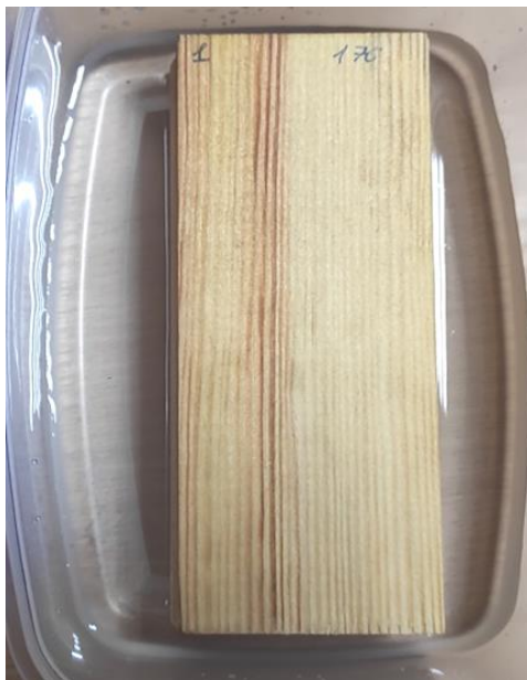
Рис. 4.22. Процес вимивання антипіренів водою із зразка деревини
