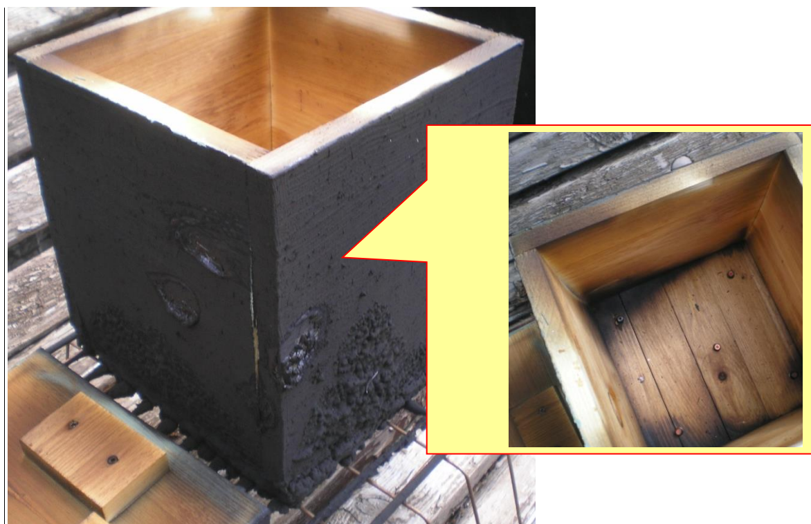
Фото 4. Результати випробувань вогнезахищеного модельного зразка тари, виготовлених з меблевого щита: а – запалювання модельного вогнища; б – початок термічного впливу; в – зниження інтенсивності горіння; г – спучення покриття; д – пригнічення горіння
