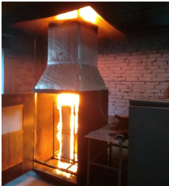
Рис. 4.14. Визначення горючості необробленої деревини
