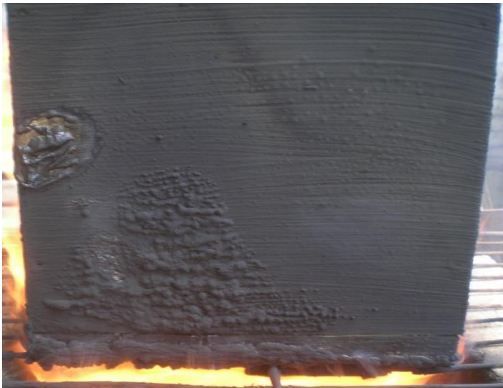
Рис. 4.29. Результати випробувань модельного зразка обробленого покриттям.
