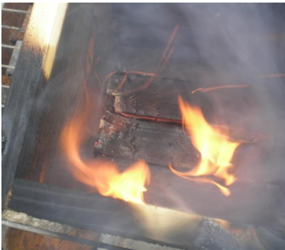
Рис. 4.28. Результати випробувань необробленого модельного зразка.
