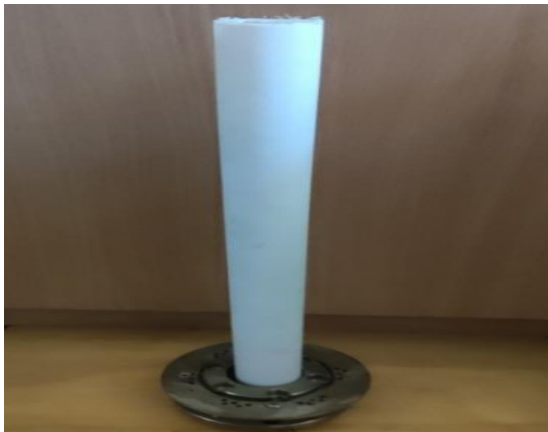
Рис. 5.1. Випробування зразка деревини на водопроникнення
