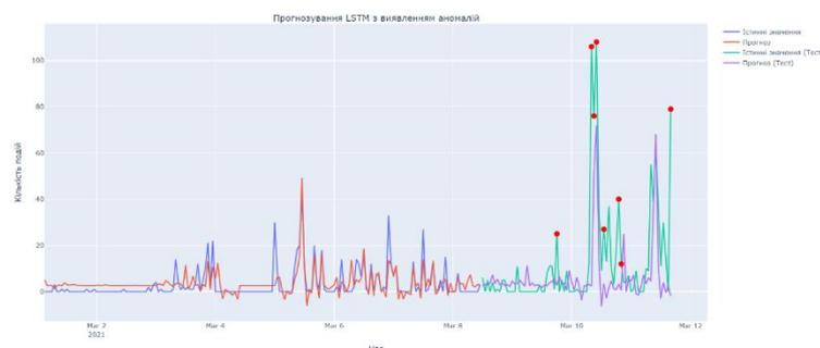
**Рис. 5.** Виявлення аномалій з використанням LSTM
