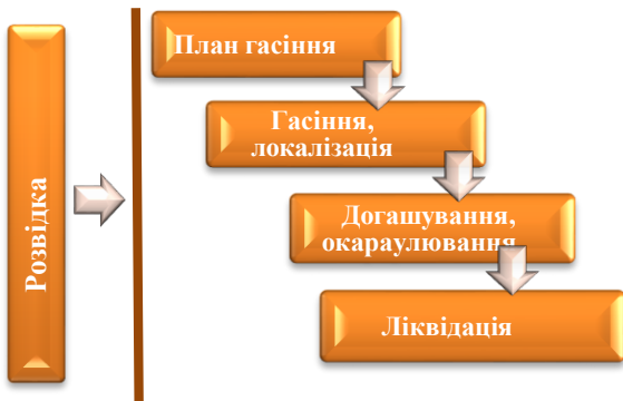
Рис. 2. Стадії гасіння лісових пожеж
