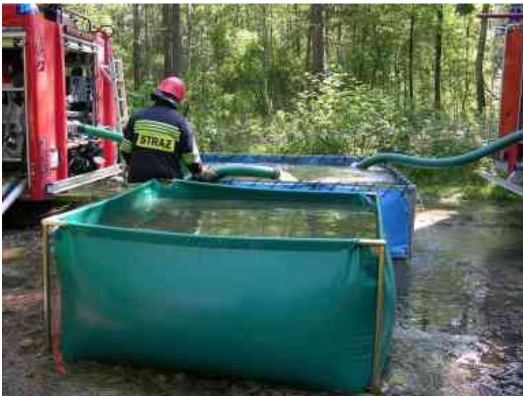
Рис. 2.11. Приклад використання мобільних резервуарів для води під час реагування на лісову пожежу (фото із сайту http://surl.li/zhqm )
