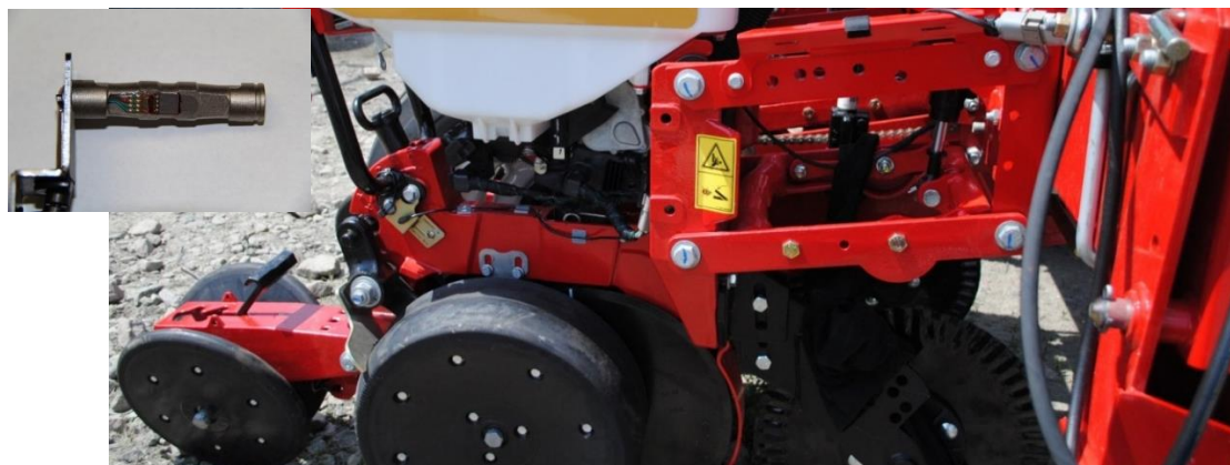
Рис. 2. Секція сівалки MF 9108VE з сенсором системи Delta Force у лівому верхньому куті.
