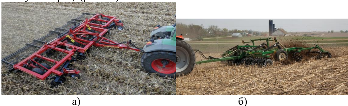
Рис. 1. Агрегат для вертикального обробітку ґрунту McFarlane SPR1000 (а) та Reel Disk (б).
