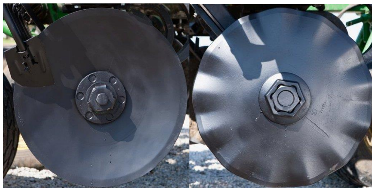
Рис. 3. Конфігурація лез дисків різних секцій машини.
