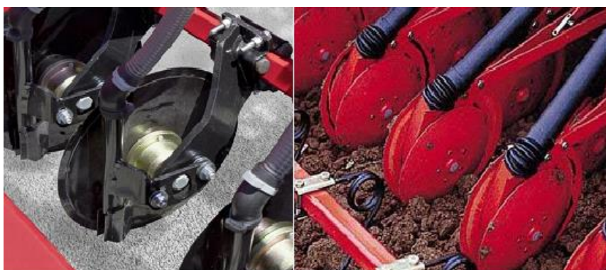
Рис. 1. Дискові сошники: а – однодисковий; б – дводисковий.
