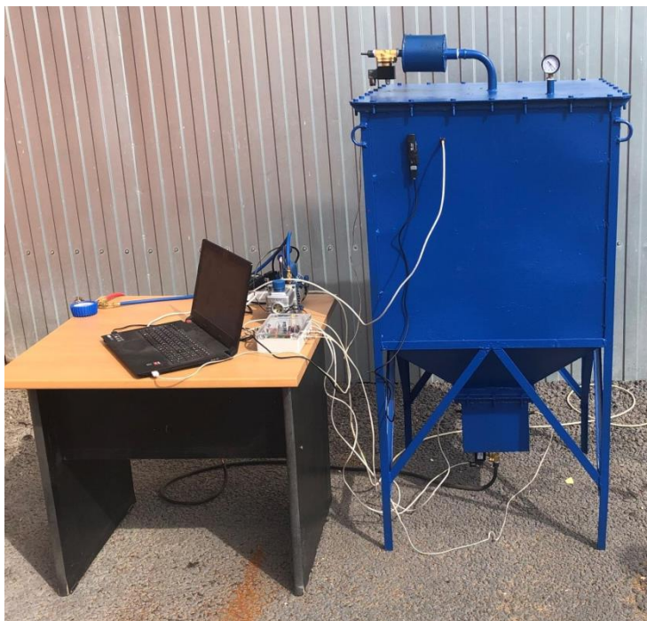
Рис. 2. Загальний вигляд герметичного контейнера для зберігання насіннєвого зерна в розрідженій атмосфері.
