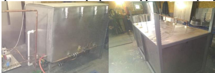
Рис. 3. Ємність генератора крижаної води в зборі.
