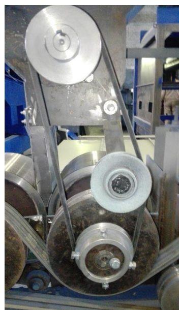
Рис. 3. Конструктивна схема приводу живильного пристрою (а), привід живильного пристрою (б): шків на живильному валу D=138 мм, шків на вальці плющення D=116 мм; шків на живильному валу D=138 мм, шків на вальці плющення D=190 мм; шків на живильному валу D=116 мм, шків на вальці плющення D=190 мм; шків на живильному валу D=116 мм, шків на вальці плющення D=116 мм.
