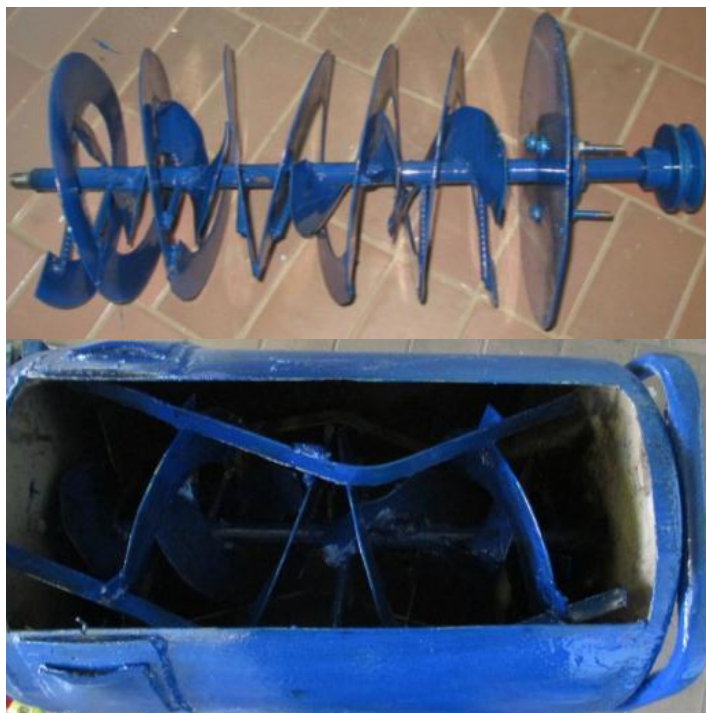
Рис. 2. Змішувальні вузли з різними кроками зовнішнього та внутрішнього шнеків: а – S_2 = 80 мм; S_3 = 120 мм; б – S_2 = S_3 = 120 мм.
