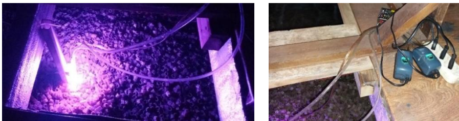
Рис. 2. Фільтр біологічного очищення вод ферми з розведення риби з носіями біомаси та встановленою аераційно-освітлювальною установкою.
