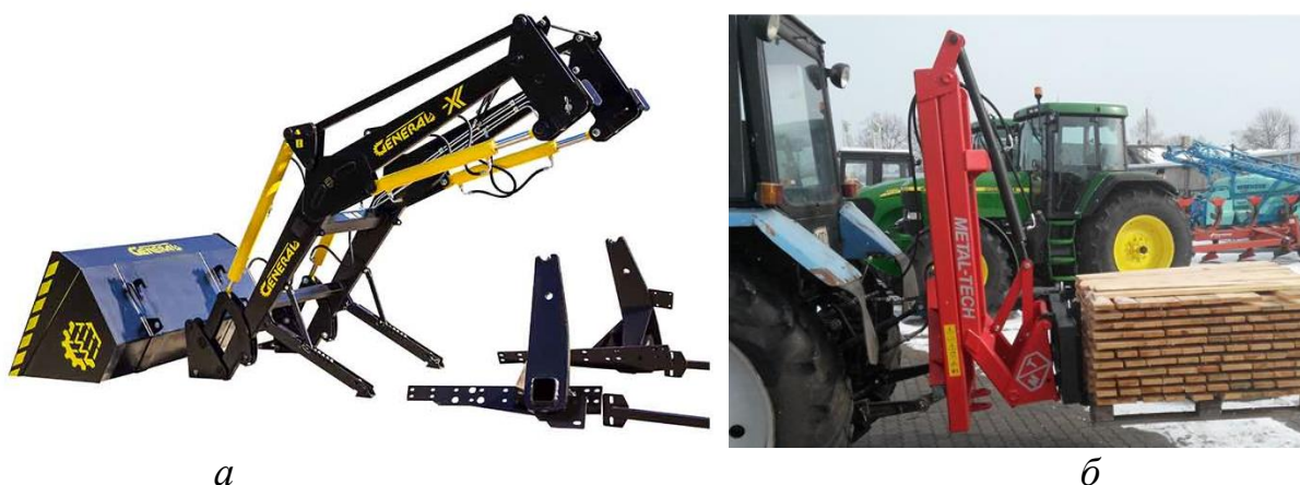
Рис. 1. Навантажувачі: а – фронтальний General Machines, б – на задню навісну систему трактора Metal-Tech.
