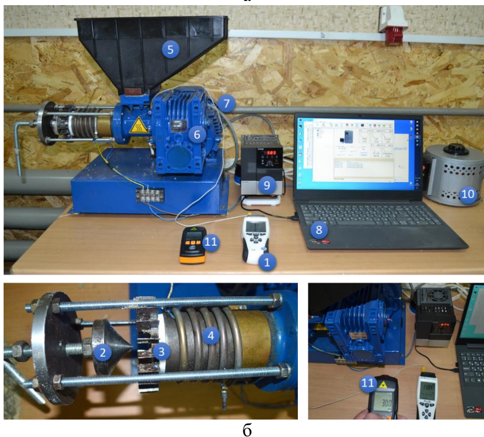
Рис. 1. Схема (а) та загальний вигляд (б) дослідної установки: 1 – цифровий термометр з термопарою FLUS ET-960; 2 – запираючий конус; 3 – гайка з роздільником потоку; 4 – повітряний ТЕН нагріву робочої камери; 5 – бункер завантаження; 6 – черв'ячний редуктор NMRV-63 (1:25); 7 – електродвигун AIP/5AI80A4; 8 – ПЕОМ; 9 – частотний перетворювач HYUNDAI N700E; 10 – лабораторний автотрансформатор ЛАТР-1М; 11 – тахометр Venetech GM8905.
