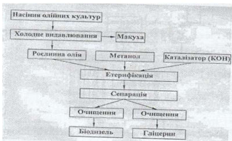
Рис 1. Схема технології виробництва біодизелю.
