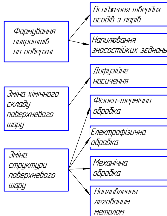
Рисунок 1 – Класифікація методів поверхневого зміцнення концентрованими потоками енергії
