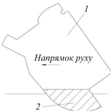
1 – корпус сошника; 2 – приварена та зміцнена полозовидна частина сошника
