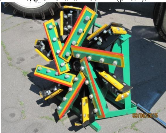
Рисунок 1 – Зразок з додатковими ножами модернізованої кидалки
