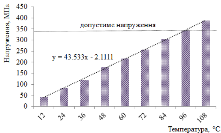
Рис. 4. Залежність максимальних еквівалентних напружень в контейнері від температури перевозимого у ньому вантажу
