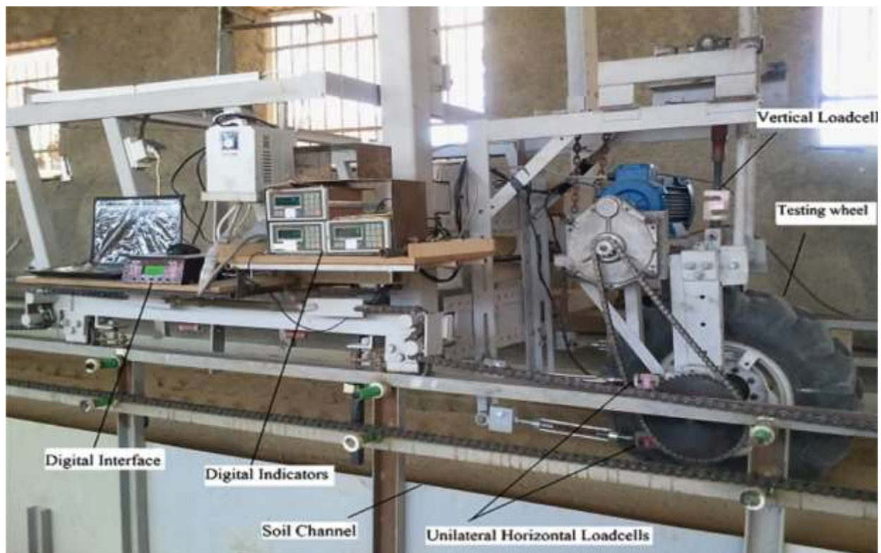
Рисунок 2 - Ґрунтовий канал для вимірювання параметрів роботи сільськогосподарських коліс [7]
