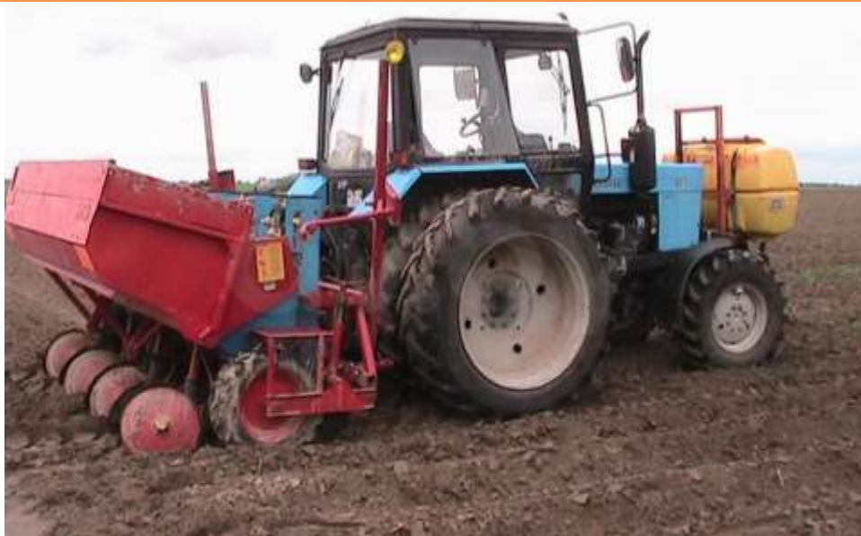
Рисунок 1 – Саджалка з механічним приводом від опорних коліс [3]
