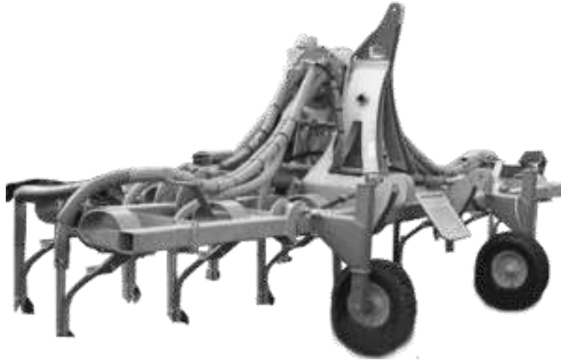
Рисунок 2 – Адаптер для внутрішньо ґрунтового внесення рідких добрив АВВ-6 [3]
