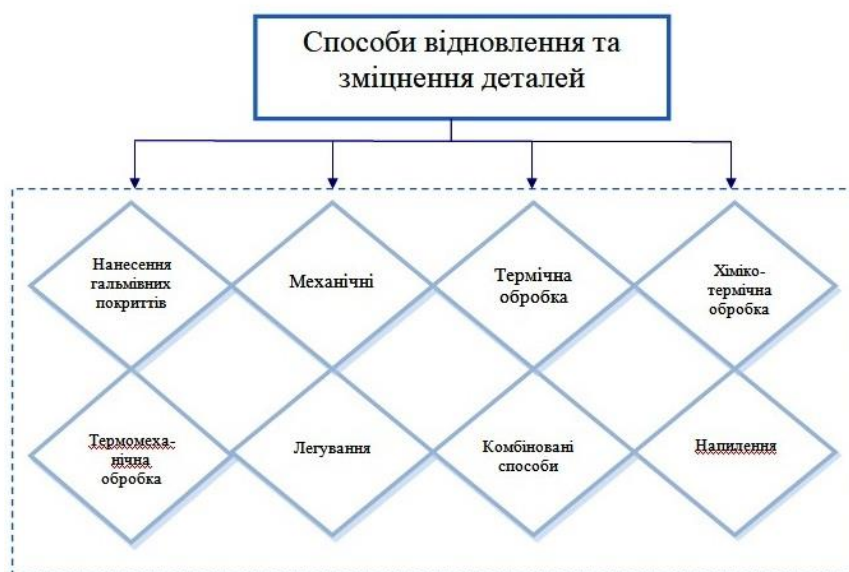
Рис. 1. Способи відновлення та зміцнення деталей.
