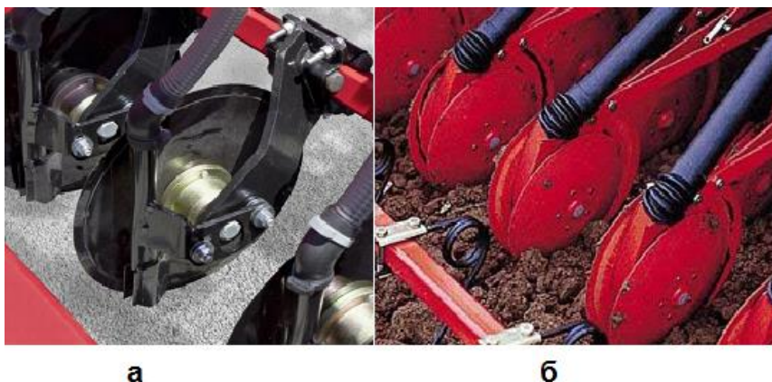
Рис. 1. Дискові сошники: а – однодисковий; б – дводисковий.
