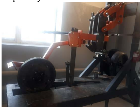
Рис. 2. Загальний вигляд експериментального зразка посівної секції.
