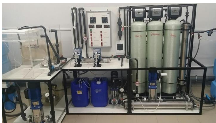
Рис. 2. Експериментальна установка очищення підземних вод у динамічному режимі.
