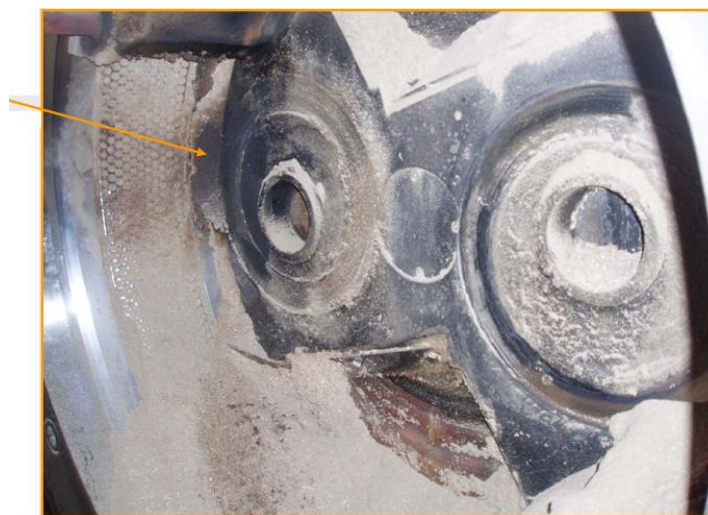
Рис. 2. Небезпечні ситуації в камері гранулювання під час роботи.
