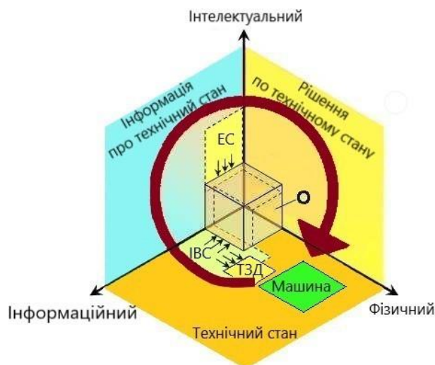
Рис. 1. Оператор в координатах: О – оператор; ТЗД – технічні засоби діагностування традиційні; ІВС – інформаційно-вимірювальна система; ЕС – експертна система.
