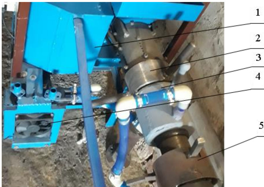
Рис. 1. Фрагменти робочих органів шнекового прес-екструдера: 1 – бак охолодження; 2 – пресуюча частина; 3 – система охолодження дожимної камери; 4 – радіатор з вентилятором; 5 – пристрій остаточного формування.
