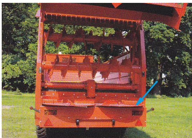
Рис. 3. Шнековий розкидальний робочий орган з горизонтальною віссю обертання у поєднанні з додатковими розкидальними дисками.
