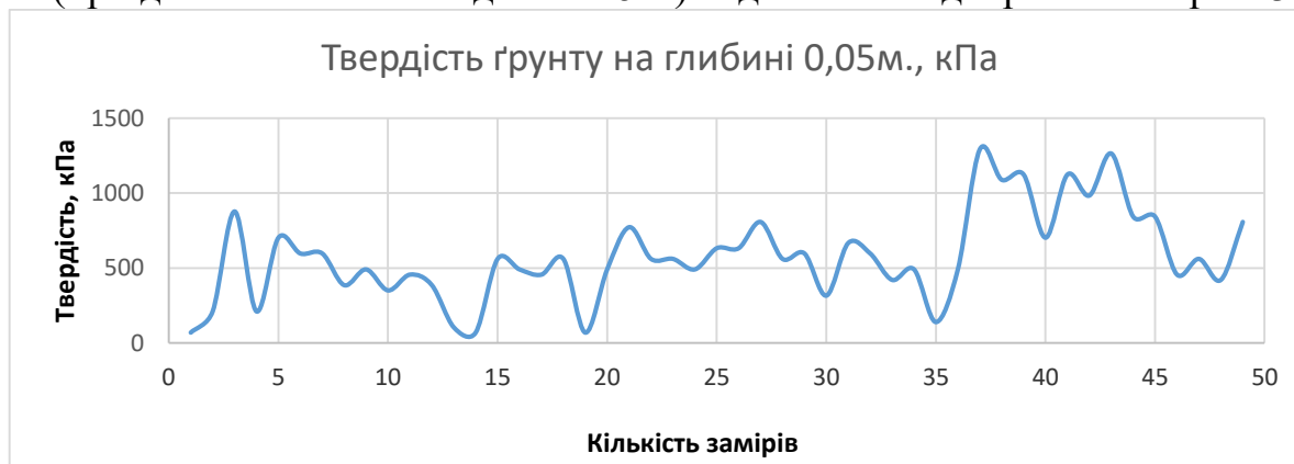
Рис. 3. Твердість ґрунту на глибині 0,05 м, кПа.
