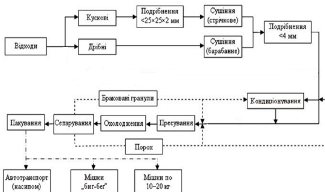
Рисунок - Технологічний процес виробництва гранульованого органічного добрива
