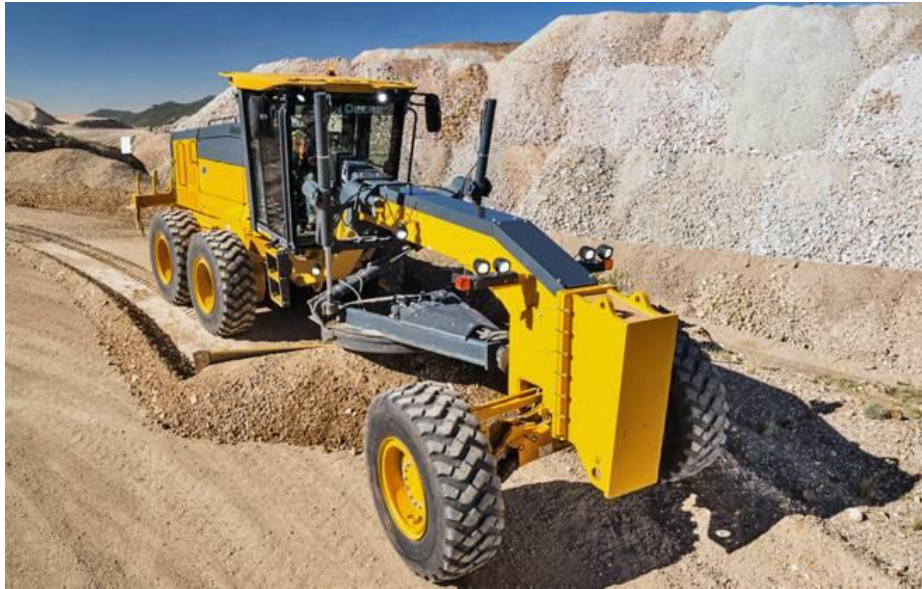
Рис 1. Грейдер - виймально-транспортна та землерийно-планувальна машина, якою планують і профілюють земляні насипи, переміщують і розрівнюють ґрунт
