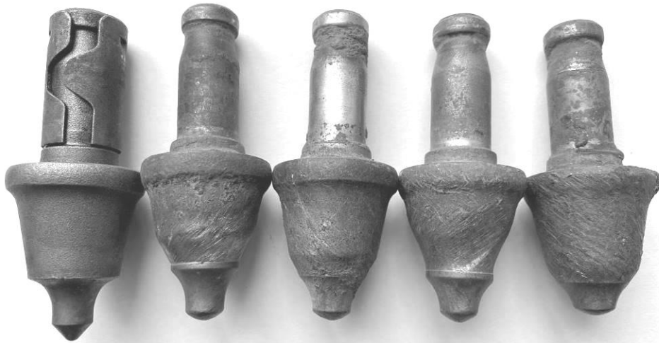
Рисунок 1 – Різці барабанних фрез: а – новий; б-д – зношені
