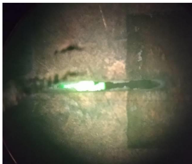
Рис. 1. Сопло щілинного гідравлічного розпилювача після неправильного чищення
