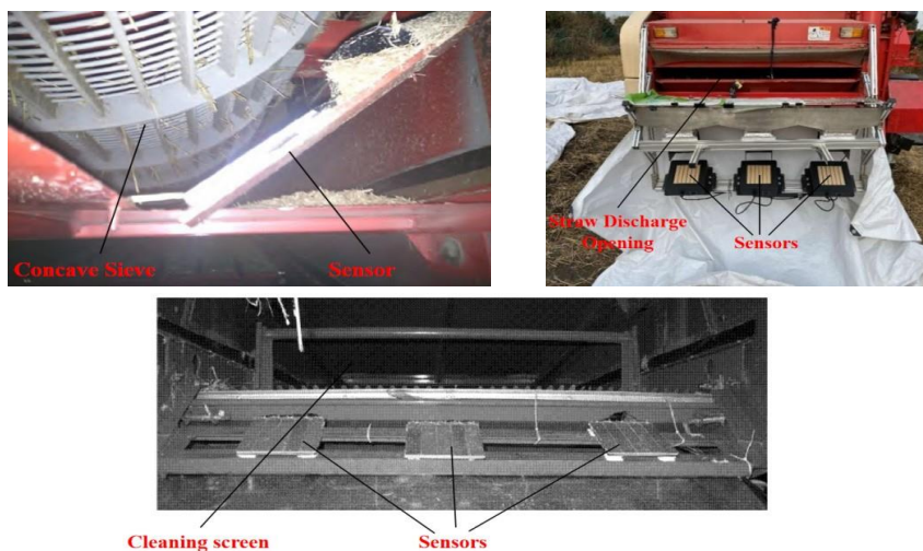
Рис. 2. Різні положення установки датчиків на комбайні.
