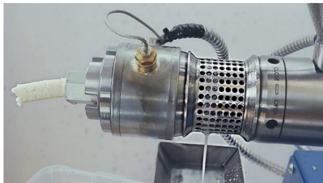
Рис. 5. Зеєрна камера шнекового преса: а – регулювання зазору між зеєрними пластинами за допомогою спеціальних приливів; б – регулювання зазору між зеєрними пластинами за допомогою шайб
