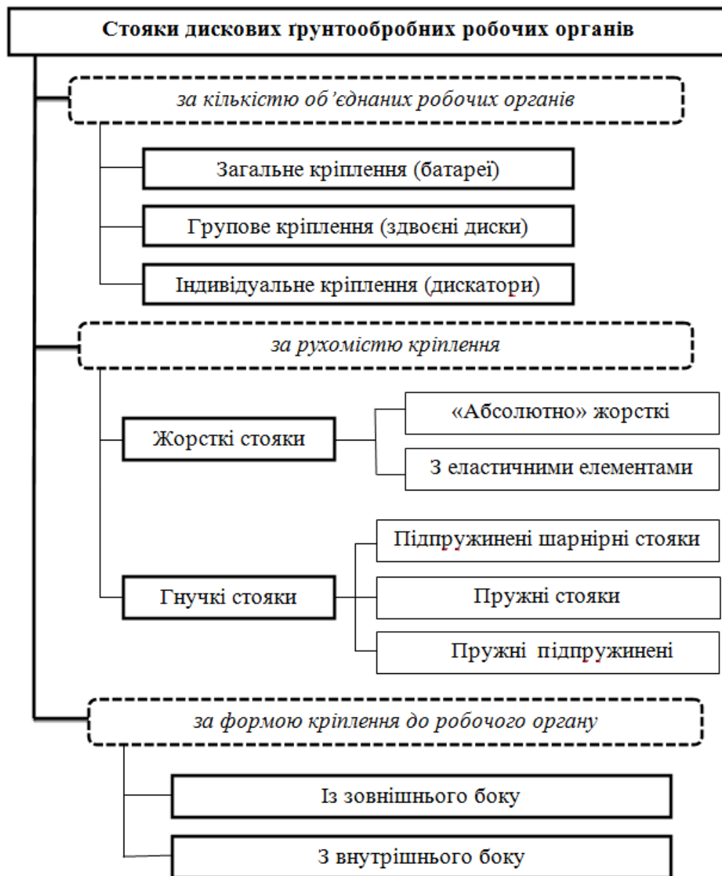
Рис. 1. Класифікація стояків дискових робочих органів за конструкцією кріплення (запропонована)
