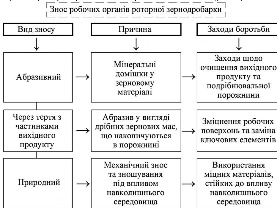
Рис. 1. Підходи до підвищення надійності та довговічності роторних зернодробарок
