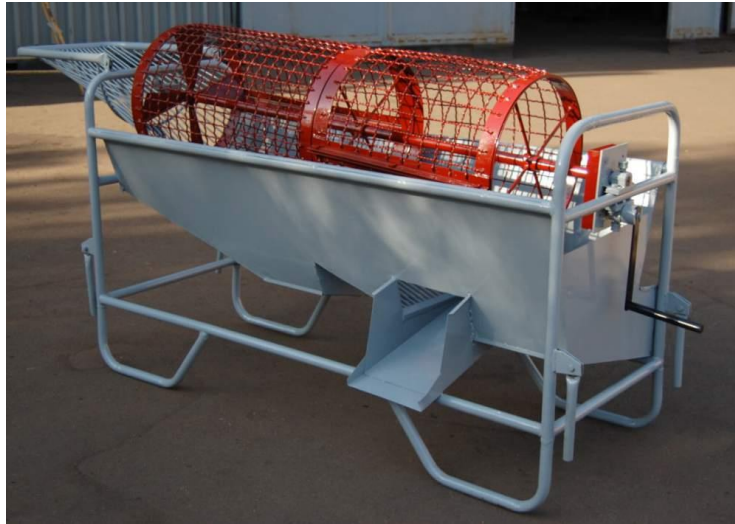
Рис. 10. Барабанна сортувальна машина з послідовним розташуванням решета
