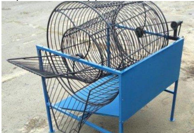
Рис. 11. Барабанна сортувальна машина з паралельним виділенням фракцій.
