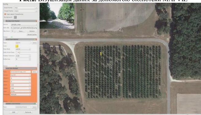
Рис. 3. Програмне забезпечення MAPVIZ, яке візуалізує карту Google, місцезнаходження GPS (жовта лінія) і живе відео (верхній лівий кут карти) з Kinect
