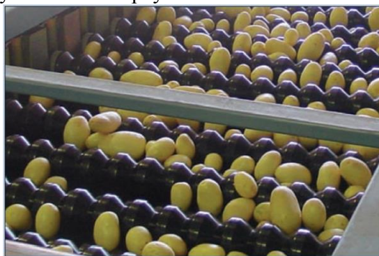
Рис. 7. Калібрування картоплі фасонними роликами
