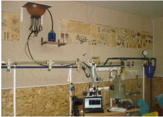
Рис. 3. Загальний вид експериментального стану доїльної установки із доїльним апаратом одночасної дії при підключенні його до нижнього молокопроводу
