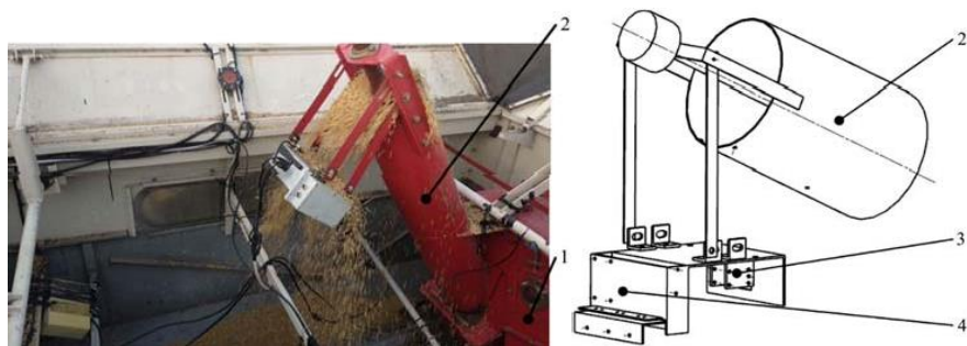
Рис. 1. Вид та структурна схема проовідбірника зерна
