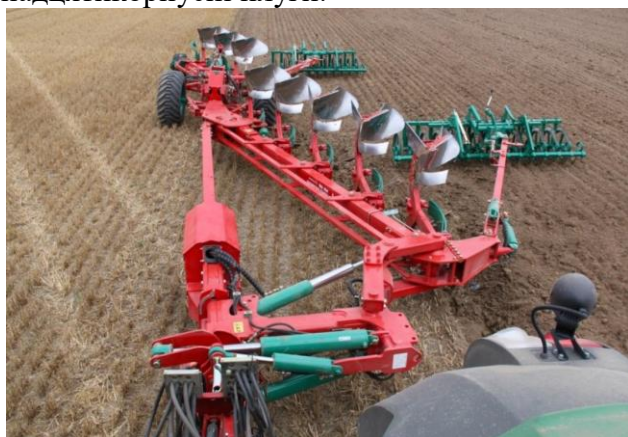
Рис. 3. Напівнавісний плуг Kverneland PW і Lemken Euro Titan виготовлений по схемі з опорним візком
