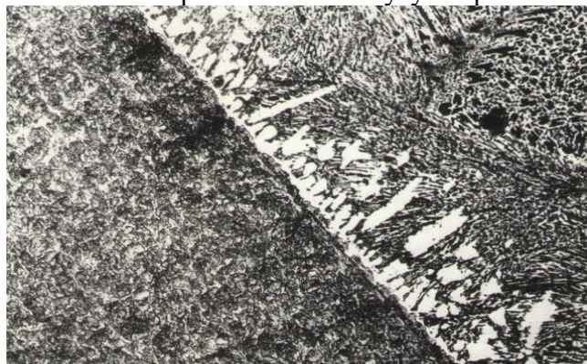
Рис. 3. Мікроструктура крапкового покриття x 320
