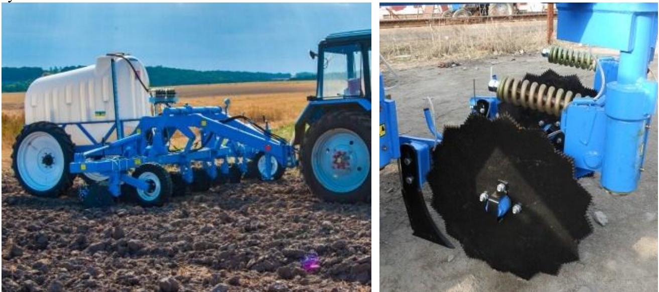
Рис. 2. Аплікатор ПЖУ-3000-6 для внесення рідких добрив
