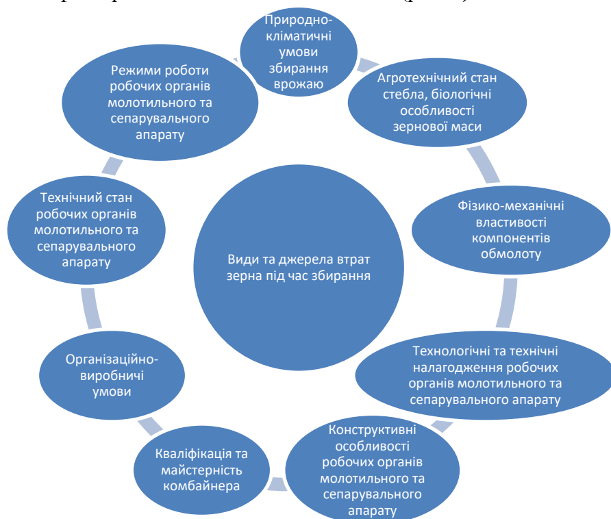
Рис. 1. Причини та фактори, що визначають величину втрат та механічних пошкоджень зерна під час збирання
