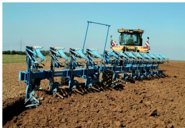
Рис. 3. Напівнавісний плуг Kverneland PW і Lemken Euro Titan виготовлений по схемі з опорним візком
