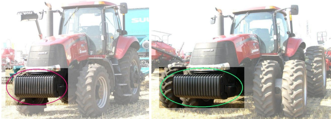
Рис. 3. Баластування тракторів CASE 310
