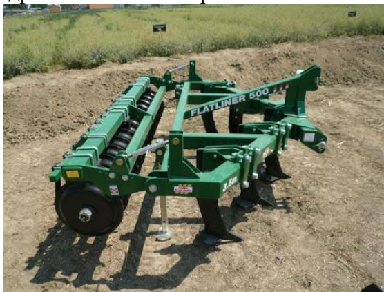
Рис. 1. Глибкорозпушувач Great Plains Flatliner 500
