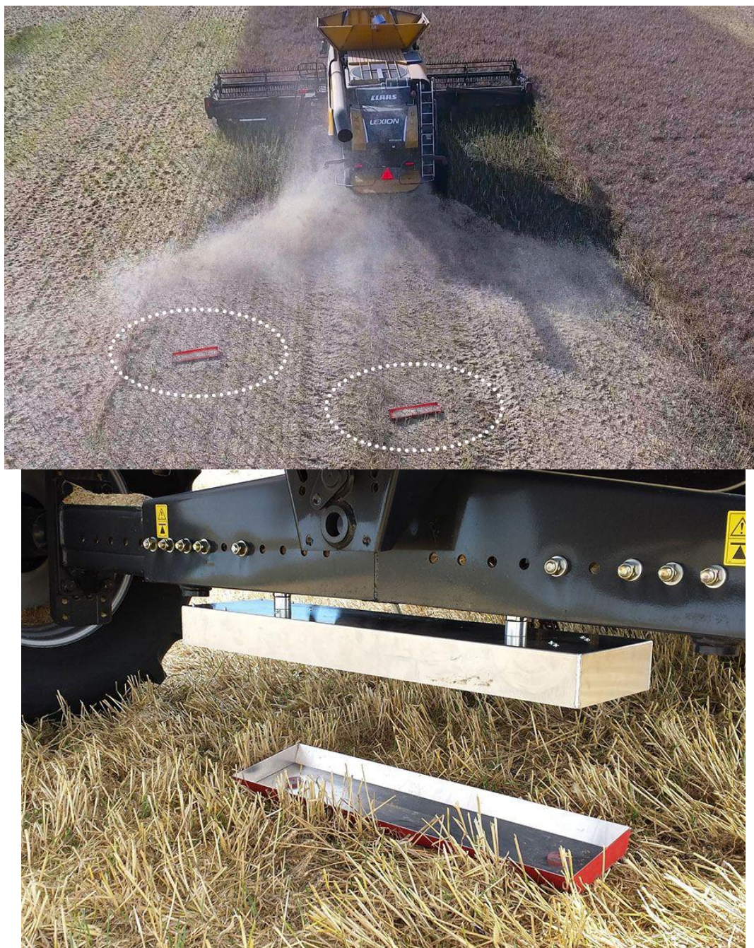
Рис. 2. Робочий момент під час взяття проби на втрати зерна – лаборант поміщає пробовідбірник між задніми колесами комбайна
