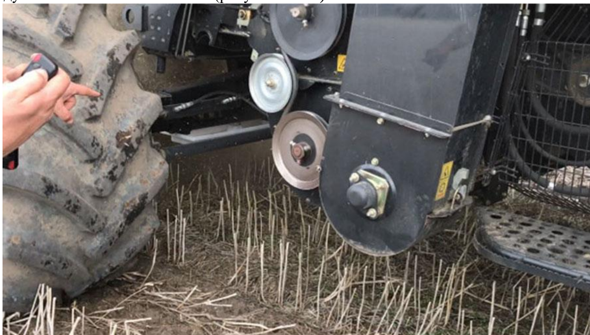
Рис. 1. Робочий момент – лаборант із пробовідбірником втрат зерна в очікуванні проходу комбайна
