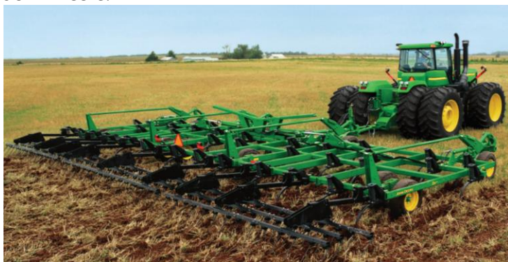
Рис. 1. Високопродуктивний чизель-ґрунтопоглиблювач моделі 2410 виробництва John Deere.
