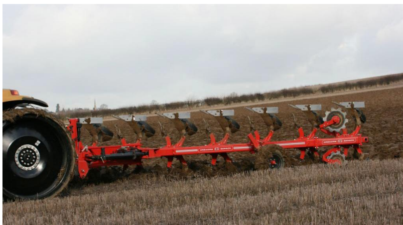
Рис. 2. Навісний семикорпусний оборотний плуг Gregoire Besson HRP-7
