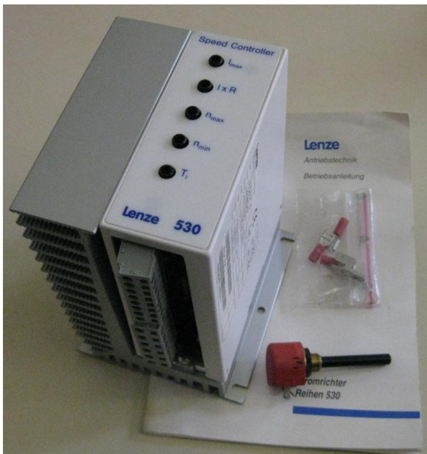
Рис. 2.1. Зовнішній вигляд тиристорного перетворювача напруги серії 530 фірми Lenze
