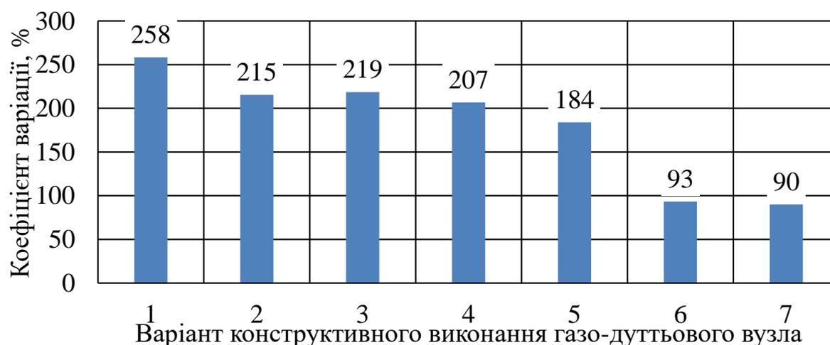
Рис. 1. Залежність коефіцієнту варіації від номеру конструктивного виконання газо-дутьового вузла газогенератора
