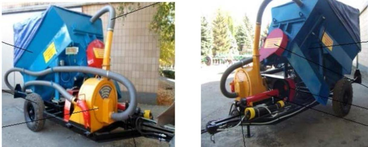
Рис. 6. Агрегат комбікормовий мобільний АКМ-3М: 1 – змішувач; 2 – ходова частина; 3 – вивантажувальне вікно із заслінкою та скатним лотком; 4 – привід змішувача; 5 – дробарка зерна; 6 – контрпривід; 7 – клинопасова передача; 8 – карданний вал; 9 – всмоктувальний рукав; 10 – нагнітальний трубопровід
