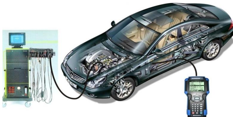
Рис. 1. Обладнання для діагностування електронної системи керування двигуном автомобіля.
