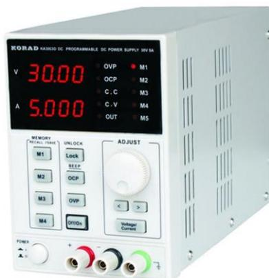
Рис. 3. Лінійний лабораторний блок живлення KORAD KA3010D.
