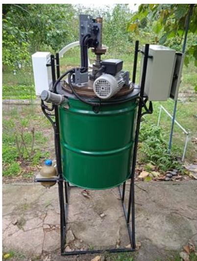
Рис. 2. Зовнішній вигляд експериментальної біогазової електротепломеханічної системи установки
