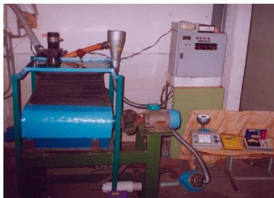
Рис. 1. Технічне забезпечення досліджень знезаражуючої дії озону. 1 – вібраційна установка; 2 – перфорований гермокожух; 3 – металевий каркас з панеллю; 4 – система подачі озонованого повітря; 5 – генератор озону з реактором бар'єрного типу; 6 – блок керування; 7 – пристрої вимірювання та автоматичного регулювання параметрів процесу.
