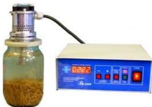
Рис. 2. Ультразвуковий обробіток насіння у воді
