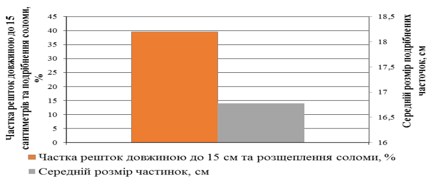
Рис.1. – Якість подрібнення пожнивних решток агрегатом DUCAT 2.5
