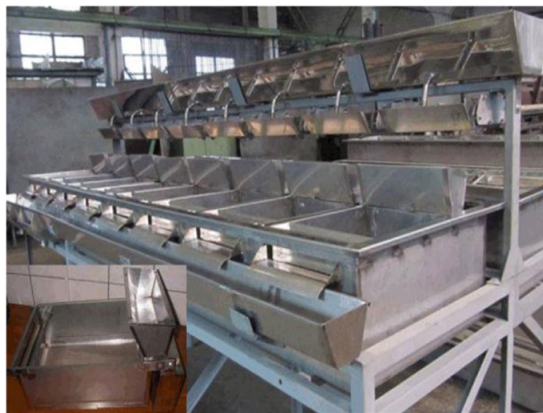
Рисунок 77 – Інкубаційний апарат «Осетер» для інкубації ікри осетрових видів риб
