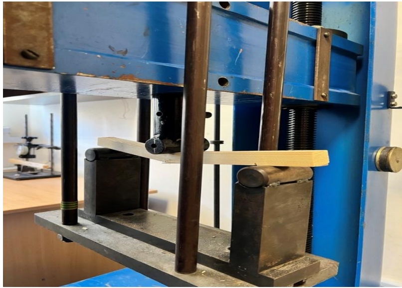
Рис. Випробування деревних матеріалів на згин на розривній машині Р-5
