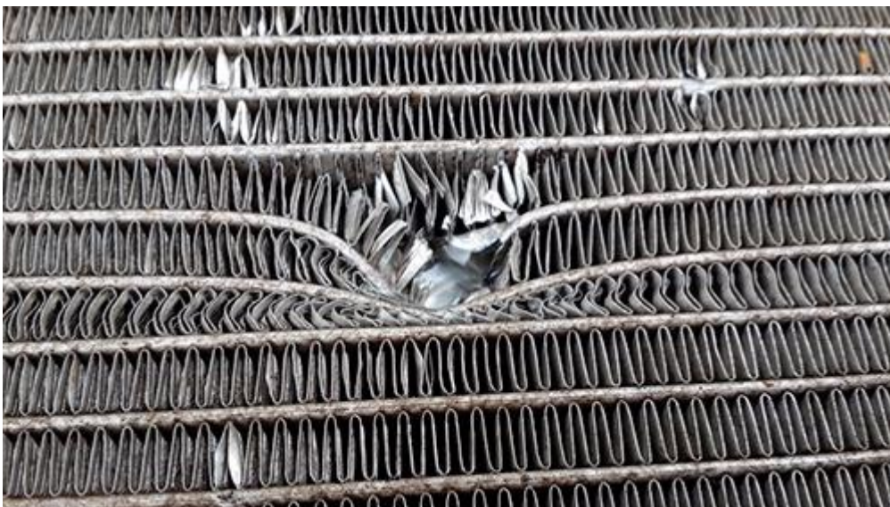
Рис. 2. Механічні пошкодження радіатора
