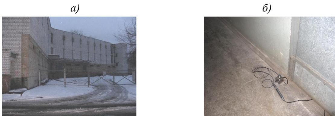
Рис. 1. Загальний вигляд будівлі (а) та розміщення датчиків вібрації на переkritті (б)
