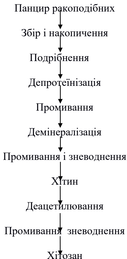
Рис. 1.1 Технологічна схема виробництва хітозану
