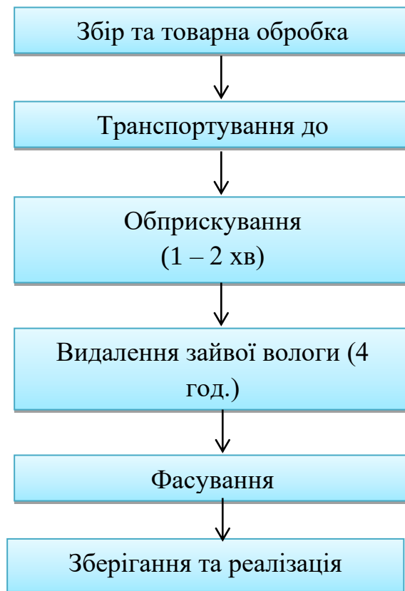
Рис. 5.2 Спрощена технологічна схема застосування попередньої обробки ягід суниці розчином хітозану.
