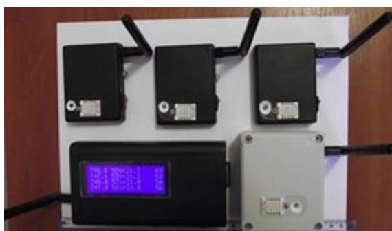
Рис. 2.5. Зовнішній вигляд автоматичного вимірювального комплексу ЕАМ- 5, електронний аналізатор мікроклімату
