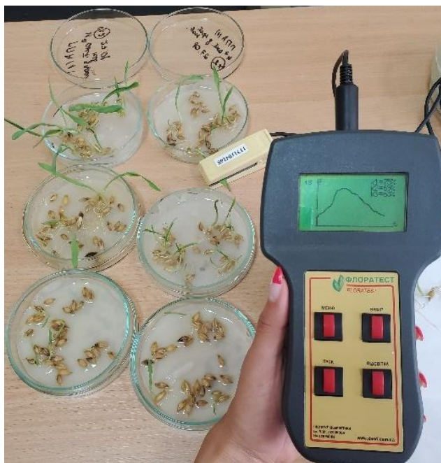
Рис. 2.5. Вимірювання індукції флуоресценції хлорофілу
