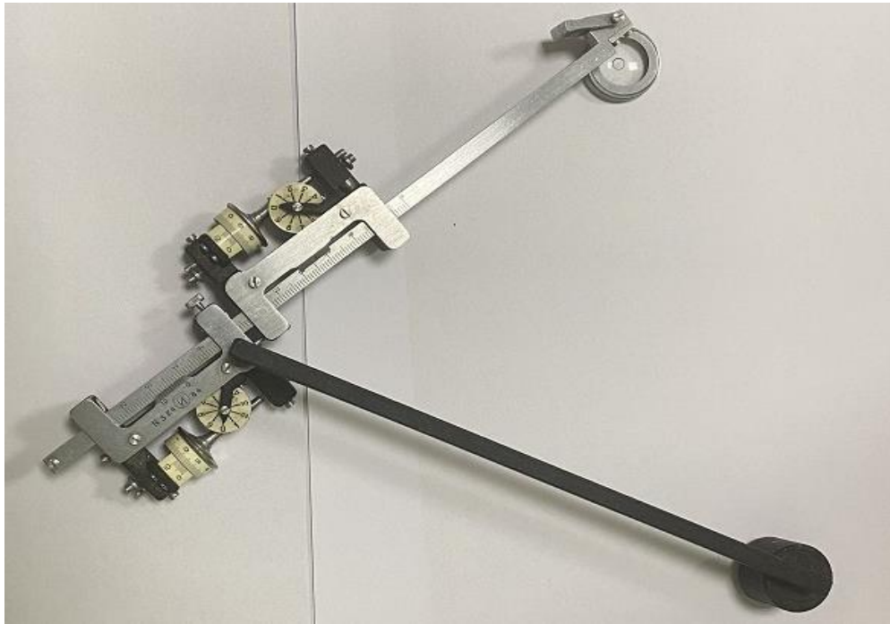
Рис. 2.8. Планіметр полярний ПП-2к, який застосовували для вимірювання площі вологої плями.
