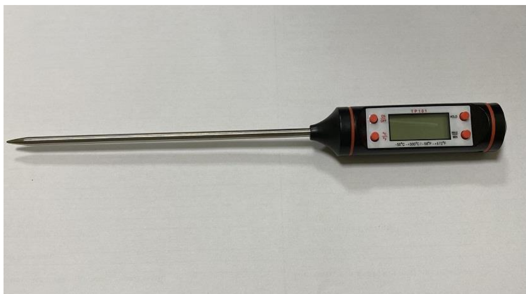
Рис. 2.3. Електронний термометр TP101, який застосовували для вимірювання температури трупів котів.
