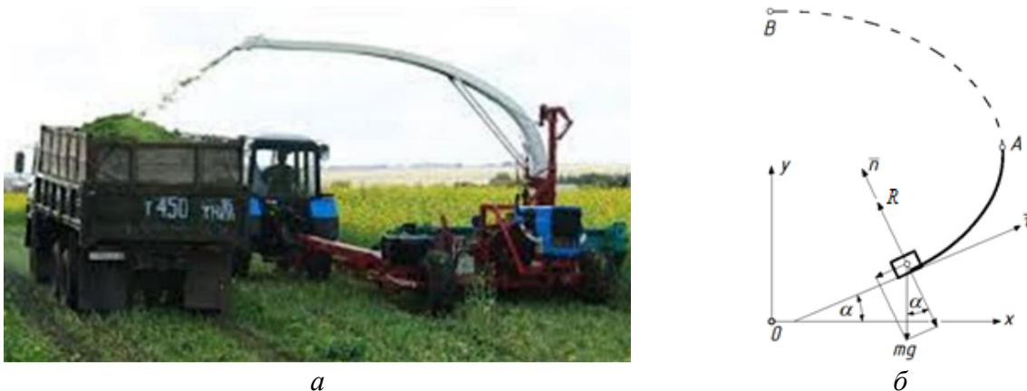
Рис. 21. Графічні ілюстрації до руху частинки по кривій лінії – осі силосопроводу: а) транспортування подрібненої маси у транспортний засіб; б) схема руху окремої частинки і прикладені до неї сили
