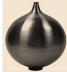
Рис. 2. Сферичний резонатор Гельмгольца
