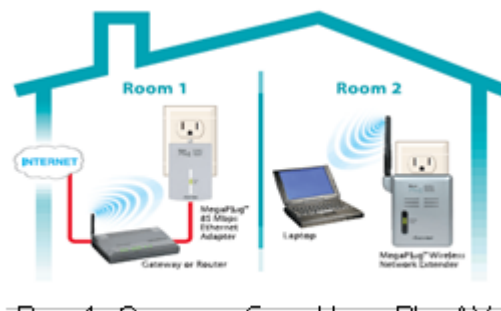
Рис. 1. Схема роботи HomePlugAV
